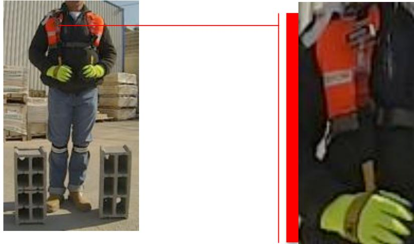
Le système de mesure, une jauge dynamométrique, est interposé entre la sangle et son attache 16A sur le gilet.
